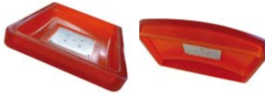
Druckstempel für Rückenlehne 250 x 200 mm, EN 1335 /1728
