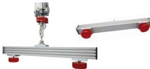
Doppeldruckstempel EN 1725 2 x Ø 100 mm L = 800 mm
