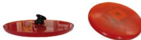
Normdruckstempel nach EN 1957 Druckstempel Matratzenprüfung nach EN1957
