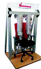
„Stuhlprüfung“ Side to Side Test
